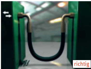
Abbildung 9: Vermeidung von Abrieb durch ausreichende Bewegungsfreiheit
