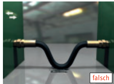
Abbildung 9: Vermeidung von Abrieb durch ausreichende Bewegungsfreiheit
