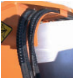
Abbildung 9: Vermeidung von Abrieb durch ausreichende Bewegungsfreiheit
