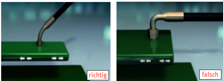
Abbildung 15: Verlegung bei Schwingungen
