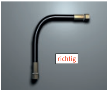
Abbildung 5: Torsion beim Einbau
